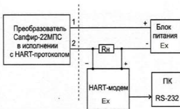
Рисунок 2.3 Схема подключения модема, исполнение Ex
