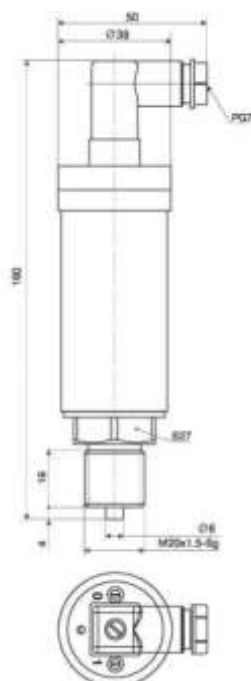
Рис.1. Общий вид, габаритные и присоединительные размеры преобразователя КРТ-5М
