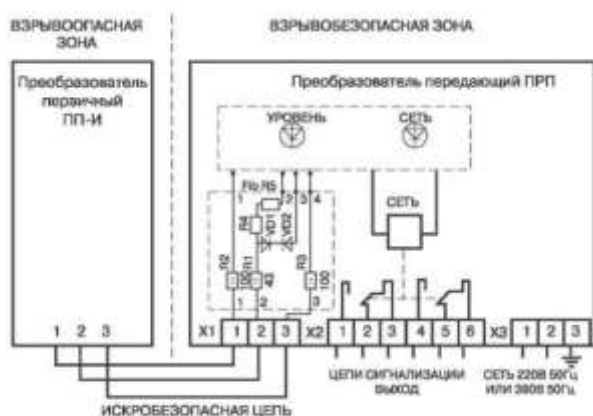
Рис. 4 Схема подключения датчика-реле уровня РОС-501И
