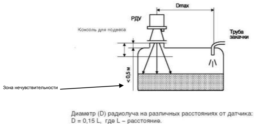
Рис. 3. Установка датчика на рабочей позиции
